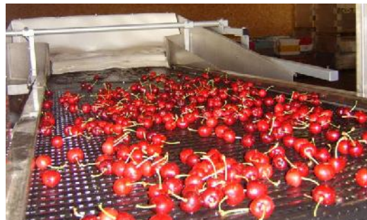
Cerezas separadas en salida del separador sobre tapiz convoyante
